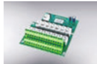
5204 16 adet ortak yangın durumu röle çıkışları
