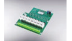
5203 8 adet ortak yangın durumu röle çıkışları
